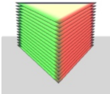
FIG. 2.10 – Chaque prisme est découpé en un ensemble de polygones parallèles. Image tirée de [DN04].
